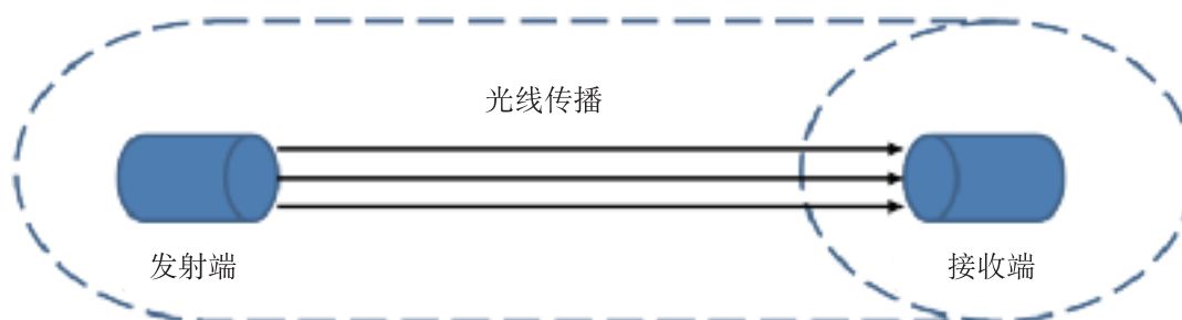
图6.4-1 TDLAS气室结构图
