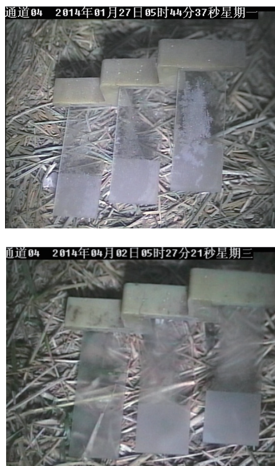
图3.2-2 结霜结露图像记录（左图：结霜，右图：结露）
