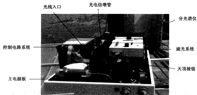
图 1-5 分光仪内部结构照片
